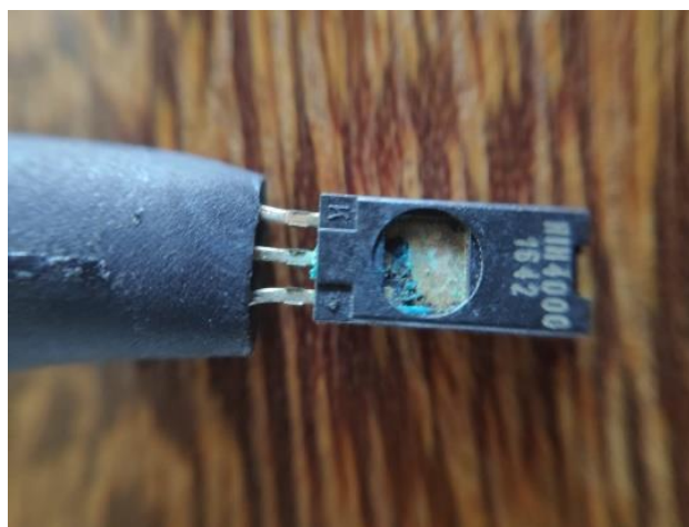
Figura 18: Sensor de humidade, utilizado no projeto WGB_Shield, que apresentava oxidação superficial após uma semana de utilização contínua.
