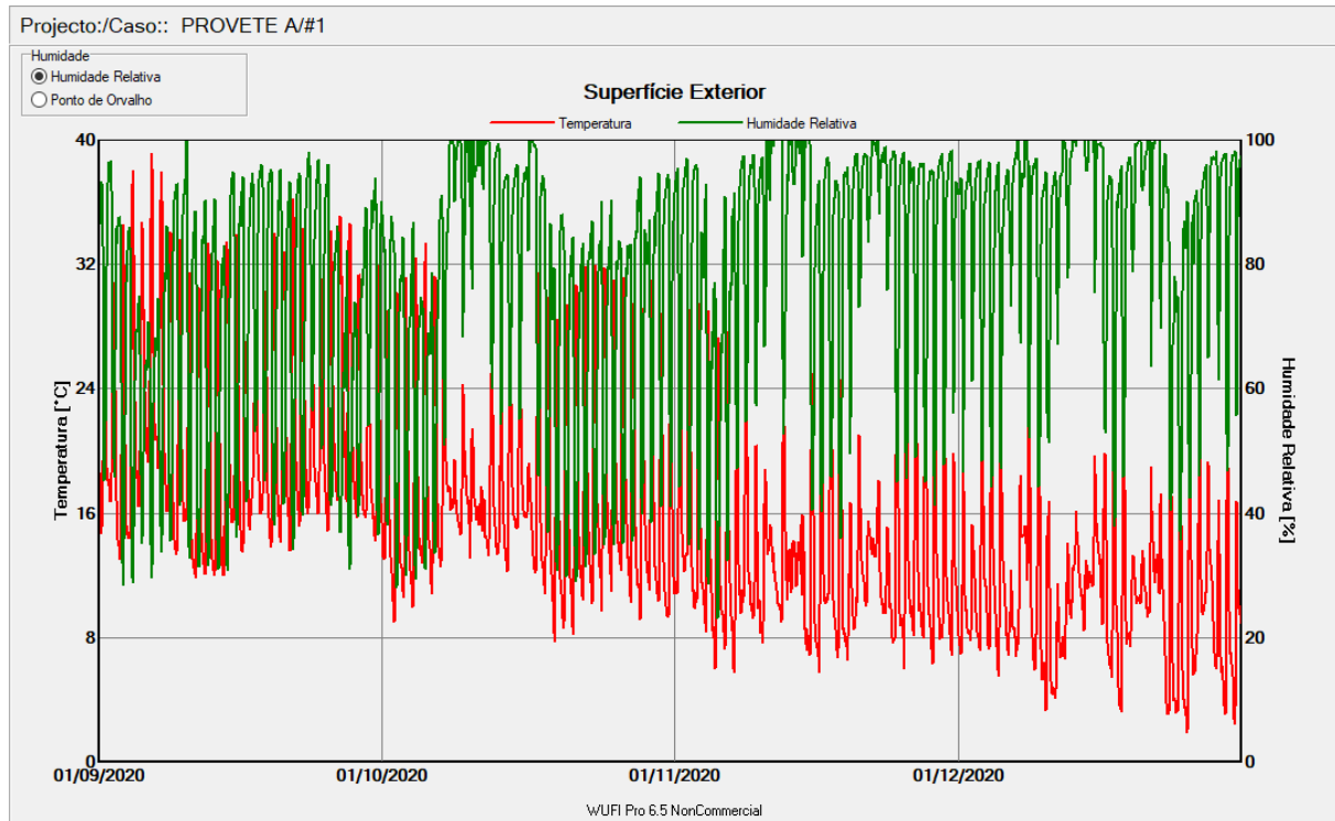
Figura 40: Simulação higrótérmica do provete S2 entre os meses de setembro e dezembro de 2020.
